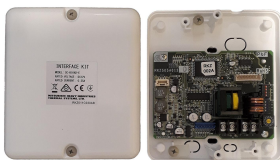
Interface koppeling SC-BIKN2-E t.b.v. bedrade bediening RAC-units
