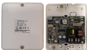
Interface koppeling SC-BIKN2-E t.b.v. bedrade bediening RAC-units
